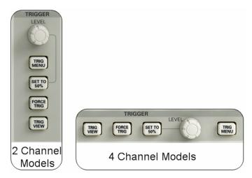
Figure 2.13: TDS1012 and TDS2024 TRIGGER controls
